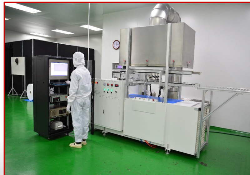
Test hiệu suất lọc HEPA Scan test for efficiency
